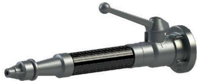
Es heißt Mehrzweckstrahlrohr, weil es die Stellung Vollstrahl, Sprühstrahl und Stopp hat; das „M“ steht für Mehrzweck. Diese Armatur dient zur gezielten Abgabe von Löschwasser bei der Brandbekämpfung. Es gibt BM-, CM- und SM-Strahlrohre.
