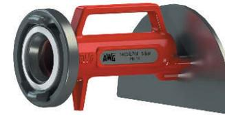
Hydroschilde bestehen aus einem Metallrohr, an dem an einer Seite zur Wasserzufuhr eine Coder B-Kupplung und an der anderen Seite eine unten flache und oben abgerundete Metallplatte angebracht ist. Sie dienen zum Schutz gefährdeter Objekte.
