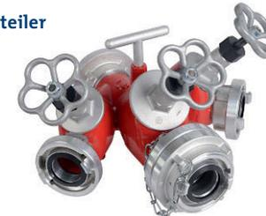
Der Verteiler ist eine mit Festkupplungen versehene Armatur mit einem B-Zugang und drei einzeln absperzbaren Abgängen (3 x B oder 1 x B und 2 x C). Er verteilt das Wasser einer Zuleitung auf mehrere Schlauchleitungen.
