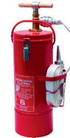
Die Kübelspritze wird bei kleineren Bränden eingesetzt. Sie enthält 10 l Wasser und ist von zwei Feuerwehrangehörigen zu bedienen. Das Wasser wird mit Hilfe einer handbetriebenen Pumpe aus dem Behälter in einen D-Schlauch gepumpt.
