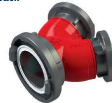
Das Sammelstück ist eine Armatur mit zwei B-Festkupplungen an den Zugängen und einem drehbaren Knaggen-Teil am A-Abgang. Es wird benutzt, um Wasser aus einem Hydranten der Feuerlöschkreislumppe zuzuführen. Dazu wird das Knaggen-Teil an den A-Eingang der Pumpe angesetzt und mit einem B-Schlauch mit dem Hydranten verbunden.
