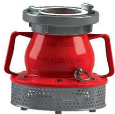
Das Rückschlagventil verhindert ein Abreißen der Wassersäule. Ein Schutzsieb verhindert den Eintritt von Verunreinigungen.
