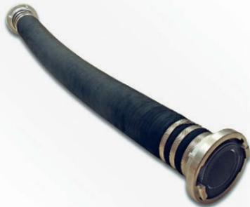
Zur Wasserentnahme nutzt die Feuerwehr den A-Saugschlauch. Der Saugschlauch ist im Gegensatz zu Druckschläuchen formstabil, sodass er sich nicht durch den Saugvorgang zusammenzieht. Er besteht aus druckfestem Gewebe, das zur Stabilisierung mit einer Metallspirale umwickelt ist.
